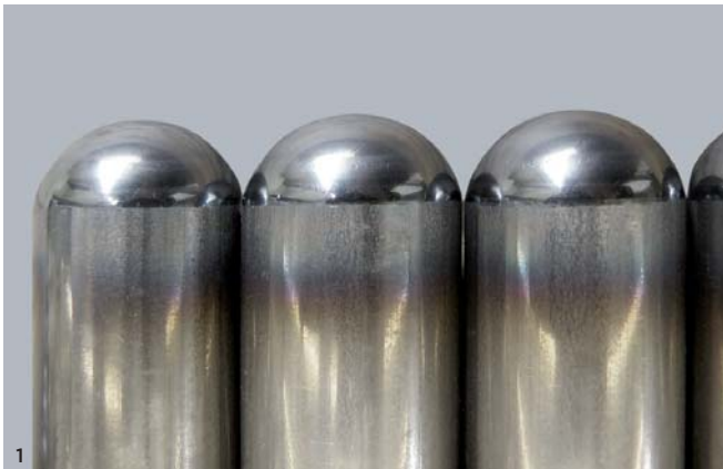
1 Um Oxidationen zu vermeiden, erfolgt die Rohrverschließung unter Schutzgasatmosphäre. 2 Mit der Atec-Rohrverschlußtechnik können unterschiedlichste Radien hergestellt werden.
