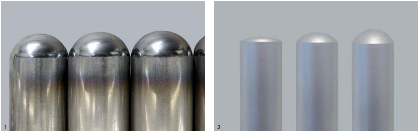
1 Um Oxidationen zu vermeiden, erfolgt die Rohrverschließung unter Schutzgasatmosphäre. 2 Mit der Atec-Rohrverschlusstechnik können unterschiedlichste Radien hergestellt werden.
